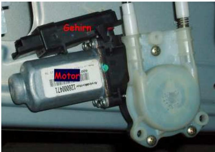
Stromversorgung und Steuerleitungen gehen über das Steuerteil (hier Gehirn genannt) zum doofen Motor.
